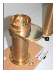
12. Zdjąć napełniacz ze zbiornika i wyjąć nóż ze szczeliny
