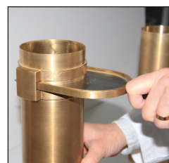
12. Zdjąć napełniacz ze zbiornika i wyjąć nóż ze szczeliny
